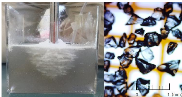
写真1 コーン貫入による透明可視化地盤の白変 (左)および溶融石英の拡大写真(右)
