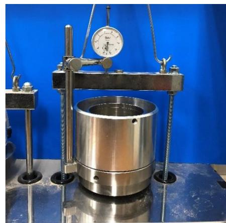
写真 1 大型の圧密試験容器
