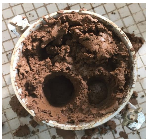
写真－1 攪拌時間 10 分の試料を突き固めた様子
