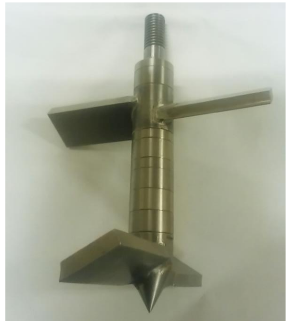
図-2 使用した攪拌翼
