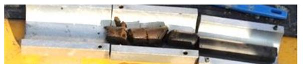
写真7 深度15.15m~のサンプリング結果
