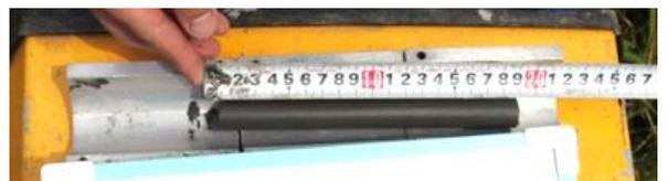
写真5 深度13.03m~のサンプリング結果
