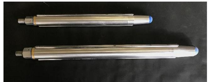
写真1 SD サンプラー(上:砂用,下:粘土用)
