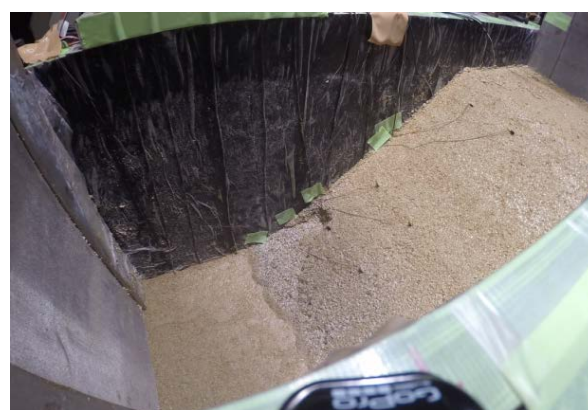
図 6 実験終了後の勾配 40 度斜面
