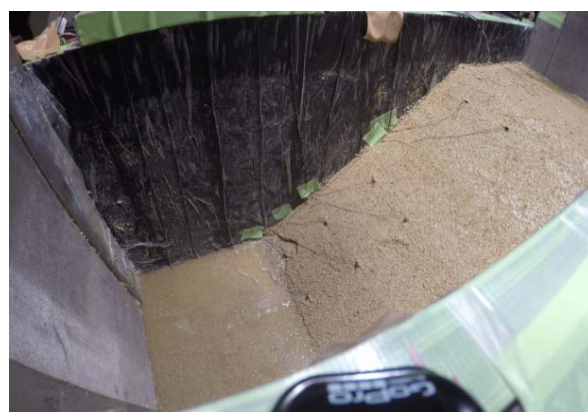
図 5 地下水上昇中の勾配 40 度斜面
