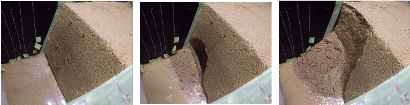
(a) 浸透性崩壊開始時 (b) ch26 付近崩壊 (c) 法肩崩落直後
