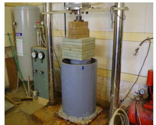
写真-3 圧密土槽 (塩ビパイプによる試料採取の状況)
