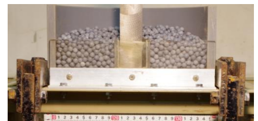
写真-2 鉛玉による拘束圧の载荷状況
