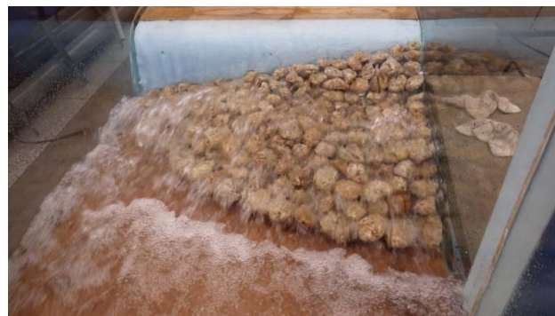
写真 9 越流水深が約 60 cm（原型）となる流況
