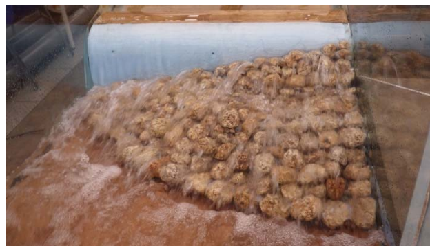
写真 8 越流水深が 44cm（原型）となる流況
