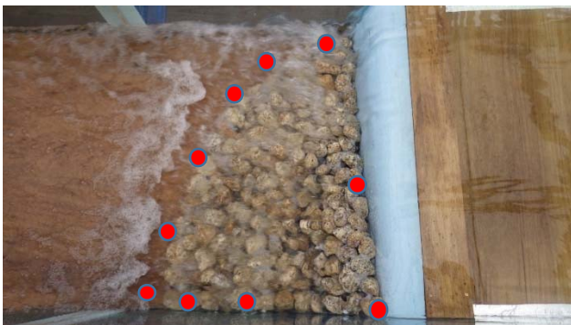
写真10 流速測定箇所
