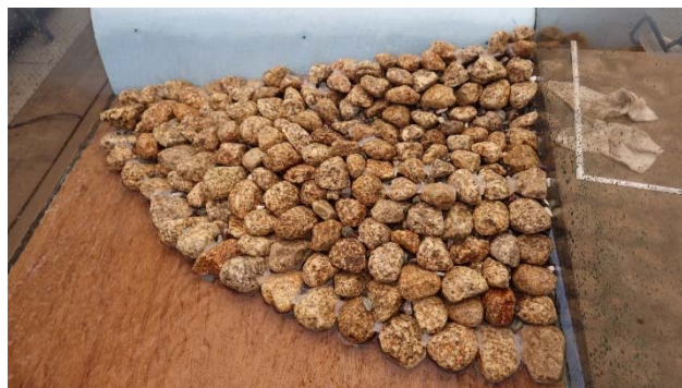
写真 7 石組みの模型実験の設定状態
