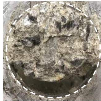
写真 2 せん断破壊面
