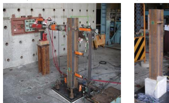
写真-1 試験体補強前と補強後
