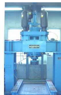
写真-2 急速載荷試験装置
