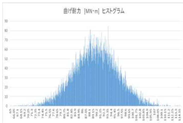
図-4 材料のばらつきが曲げ耐力に及ぼす影響
