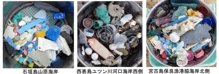
④掻き集めた表層部分の試料を5mmふるいに通過し、通過物質を収集する。
