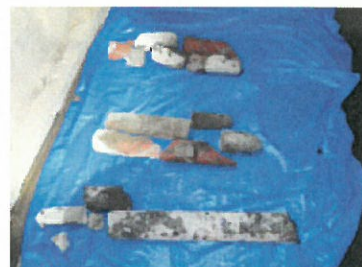
図-3 盛土内支障物
