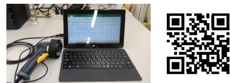
図-4 GNSS センサー付きバーコードリーダーと EPS ブロックに貼附した QR コード
