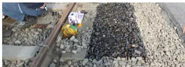
写真－5 道床横抵抗測定（道床安定剤）
