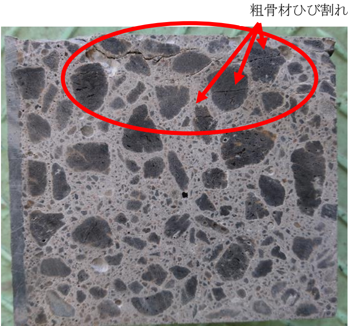
図-2 材齢 3 日の圧縮後の断面図 (W/C=55%)
