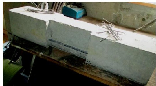
図-2 RCはり試験体(写真)
