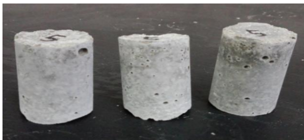
写真1 試験片 (凍結融解前)
