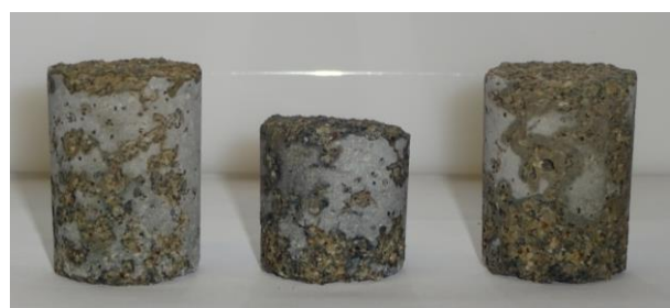
写真3 スラグ置換率 65%(BC6000):26 サイクル
