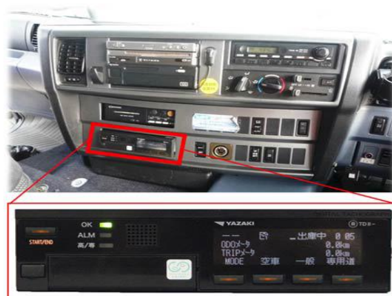
図-1 デジタコ・ドラレコ一体型車載器 DTG7
