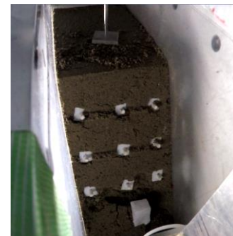
写真3 補強斜面崩壊後
