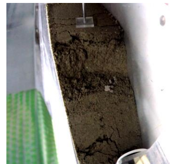
写真2 無補強斜面崩壊後
