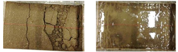
(a) 不飽和クラック ( S_{r0}=55\% , S_{rf}=71.7\% ) (b) 不飽和液状化 ( S_{r0}=60\% , S_{rf}=82.5\% ) 写真1 小型土槽 ( \rho_{d0}=1.30 \text{ Mg/m}^3 )
