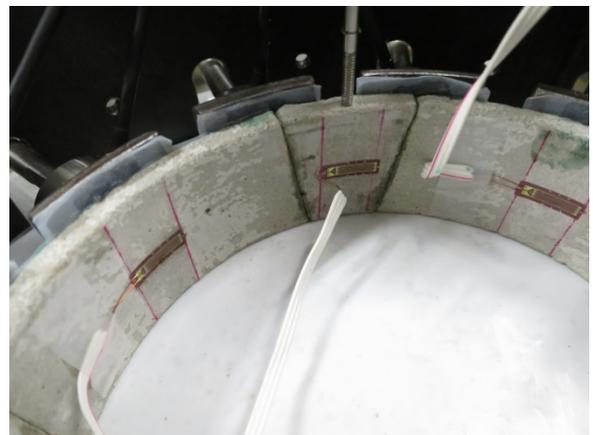
写真-2 ひずみゲージ
