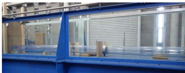
写真1 透明塩ビ管の設置状態
