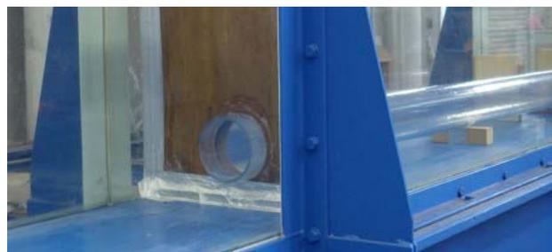
写真2 貯留池のモデル化のために設置した止水板
