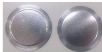
図-2 実験に用いた目皿 左) 平形目皿 右) 丸形目皿
