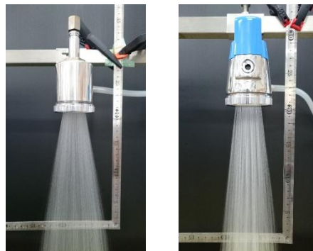
図-3 流水の様子 右) Aヘッド+平皿 左) Bヘッド+丸皿
