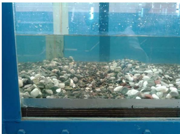
写真 4 横断方向に設置した bump の拡大写真
