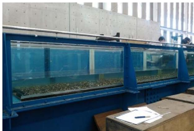
写真2 水路中6m区間に砂利を引いた状態
