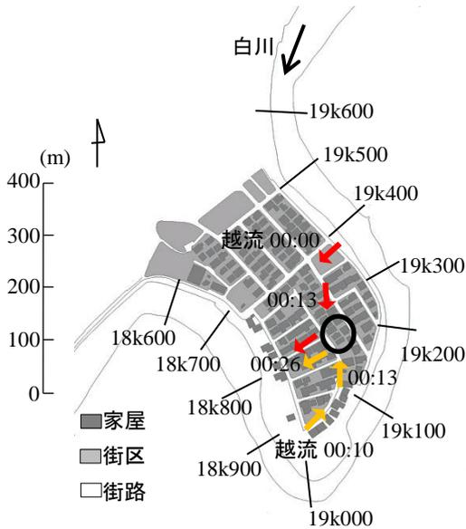
図3 流量 2300m<sup>3</sup>/s 時の浸水経路
