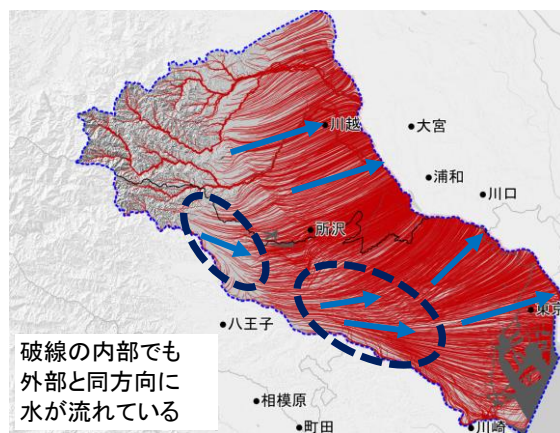
図-7 b) 水道揚水停止ケースの流跡線
