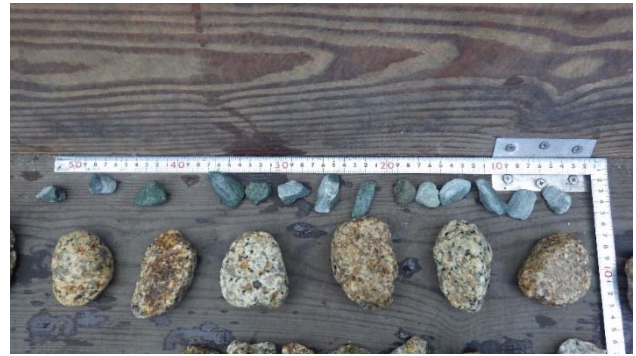
写真5 実験で使用した石（比重 2.6）
