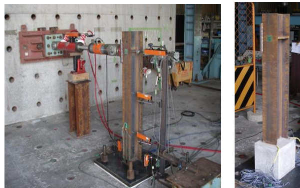
写真-2 試験体補強前と試験体補強後
