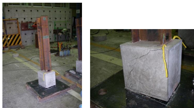
写真-3 試験体補強後の水平載荷試験後の状態
