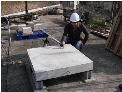
図2 コンクリート模擬供試体 (1m×1m×150mm)<sup>2)</sup>
