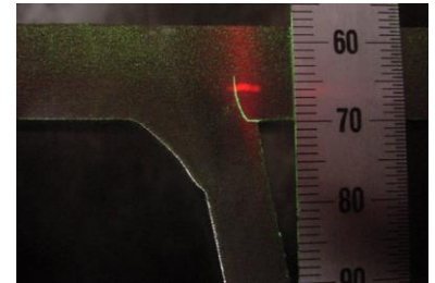
図-1 デッキ進展き裂 (模擬き裂試験片による)
