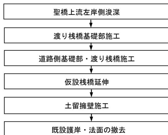
図-3 仮設栈橋施工フロー
