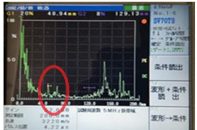
図-4 損傷深さ 1.7mm 測定時の波形
