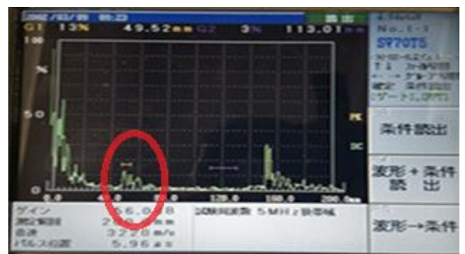
図-3 損傷深さ 1.05mm 測定時の波形
