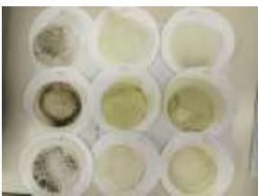
図-4 沈殿した腐食生成物
