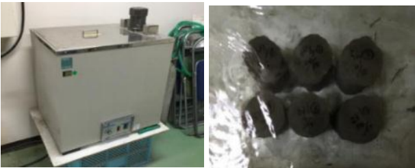
写真-1 恒温器及び水中養生の様子
