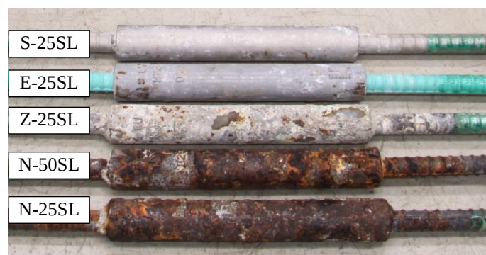
図2 腐食促進試験後の試験体
