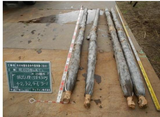
写真-2 掘り出し後の杭全景
