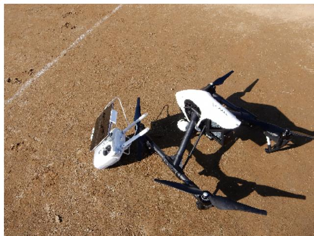
写真 1 4K カメラを搭載した UAV
