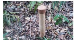
写真-4 加速度センサー(子機)
