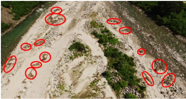
図-5 滞筋に沿って堆積している流木の例 (約 18.2kp)
