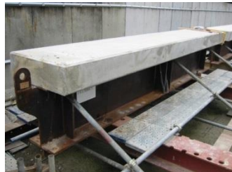
写真 2-2 合成桁供試体
