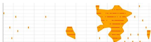
図-5 B 橋異音マップ図②
