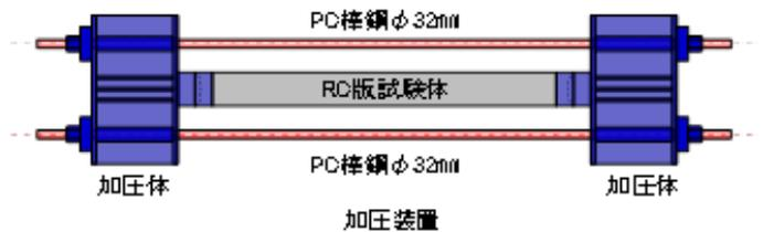
図-6 加圧装置の概要
