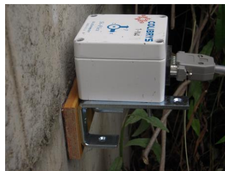
図-2 橋脚に取り付けた加速度計
