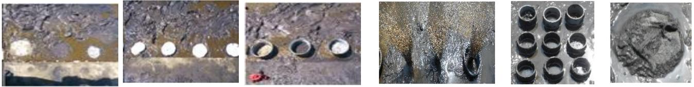
① 基本構造    ② 底質安定化構造    ③ 水供給型構造    ④ 生物生息場構造    ⑤ 複数型水供給構造    ⑥ 水供給・生物生息場構造
