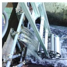
図1 ピコ水力発電機
