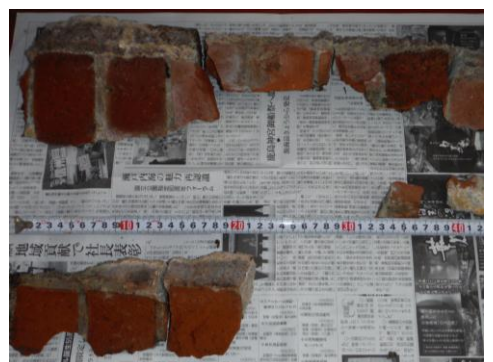
写真-6 レンガ・吹付コンクリート付着状況
