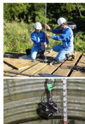
図-2 画像計測用カメラの挿入状況
