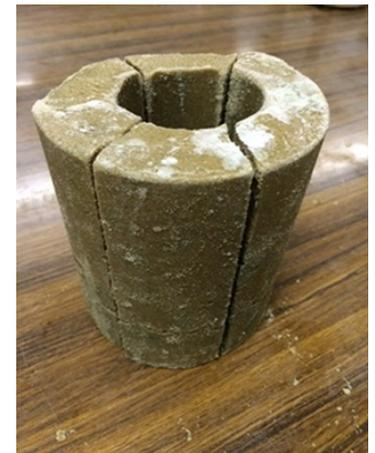
図-6 割裂破壊の様子
